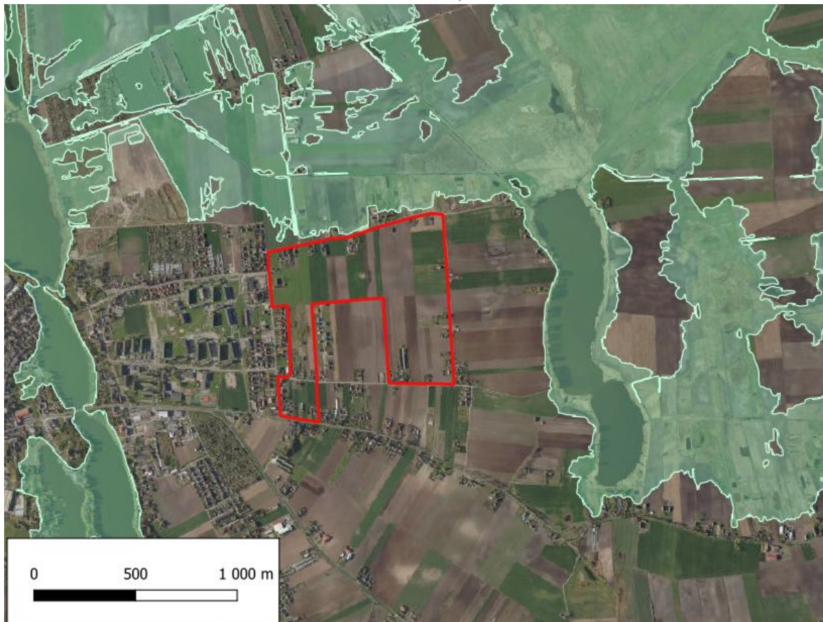
Rysunek 18. MZP z głębokością wody 0,2% (raz na 500 lat)
